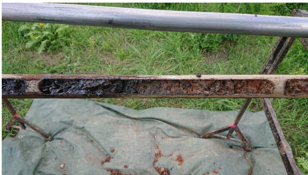
Abbildung 6: Sondierung 7/22 mit organoleptischen Auffälligkeiten
