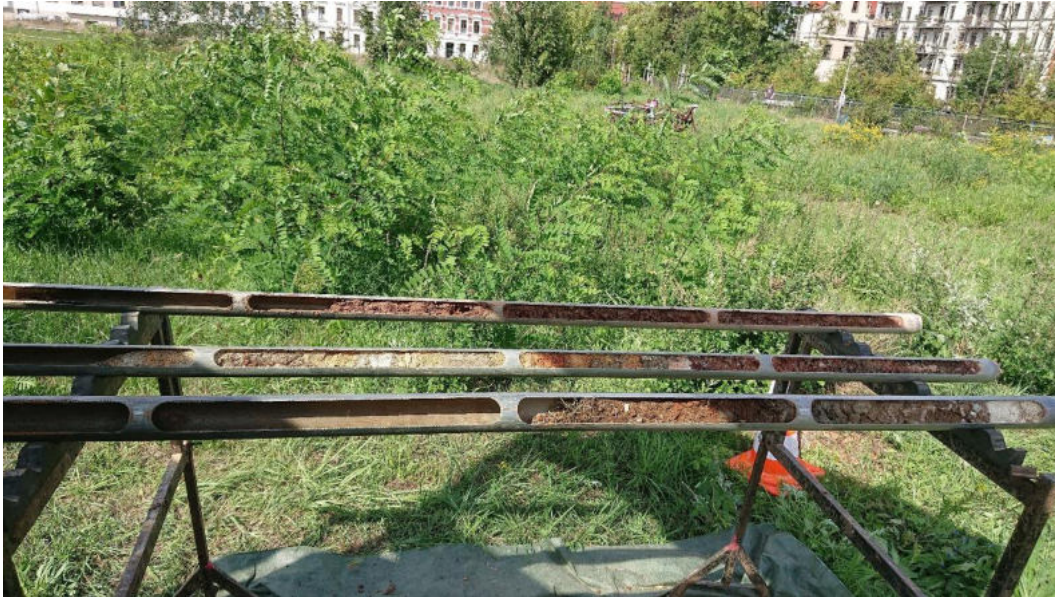
Abbildung 7: Sondierung 8/22 mit organoleptischen Auffälligkeiten
