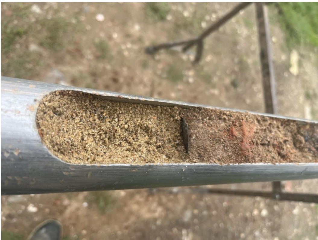
Abbildung 4: Sondierung mit Abdichtungsfolie
