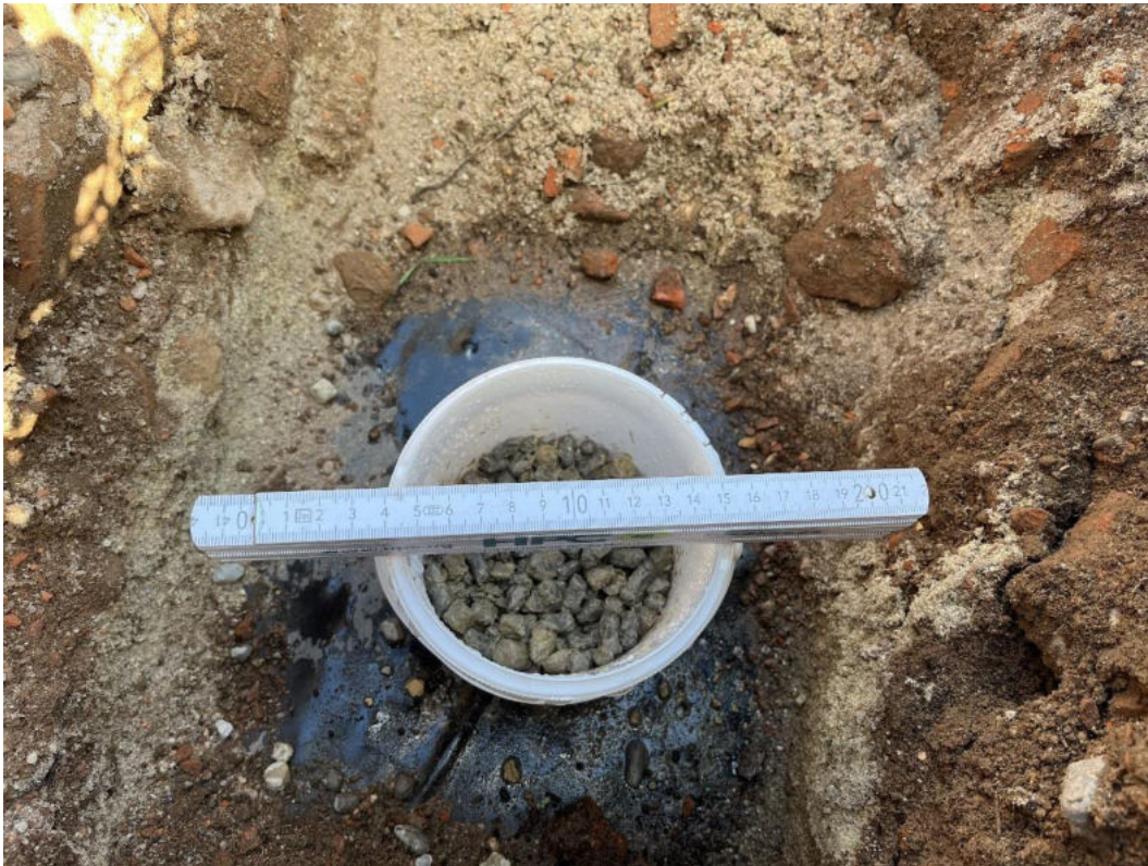
Abbildung 13: Bemessung des Durchmessers der Form
