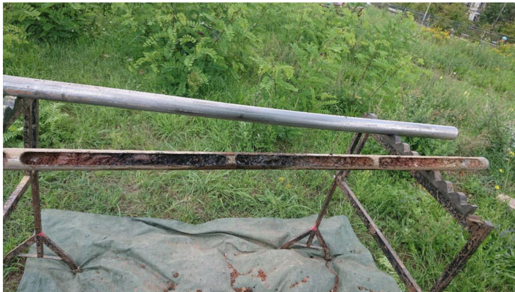
Abbildung 5: Sondierung 7/22 mit organoleptischen Auffälligkeiten
