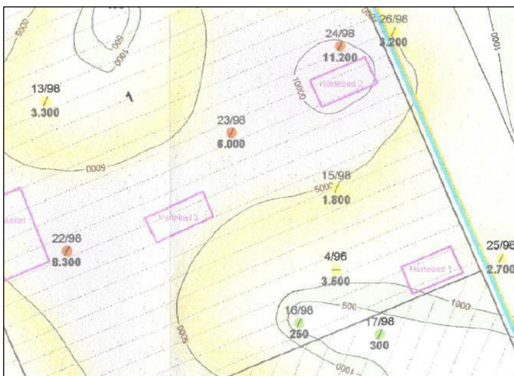
Abbildung 3: MKW-Konzentrationsverteilung Teufe 0,0 – 1,0 m u. GOK (aus [2])
