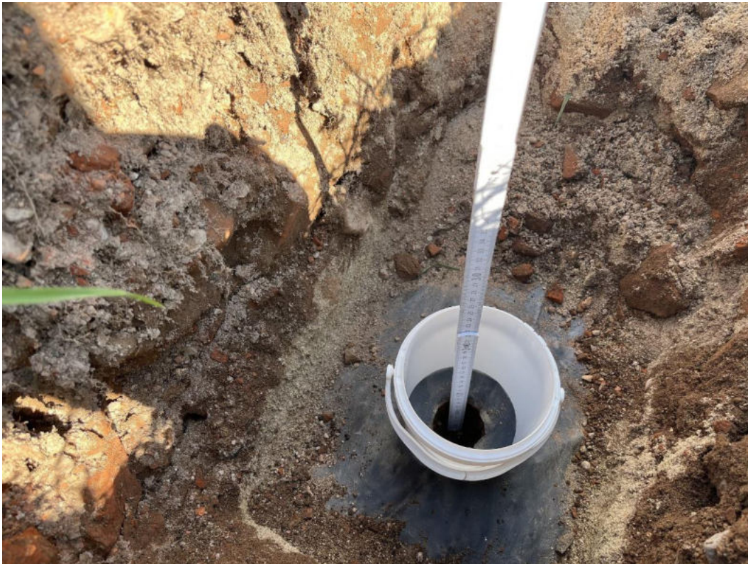
Abbildung 11: Aufsatz der Verfüllungsform für Tonpellets
