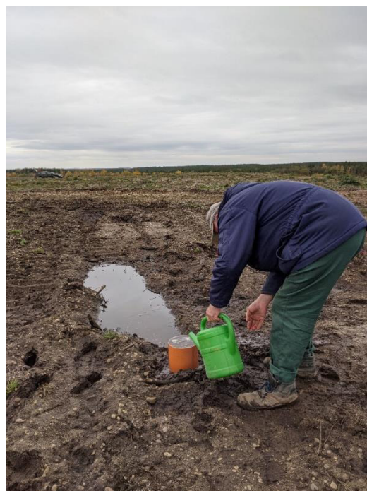
Abbildung 3-3: Befüllen des Infiltrometerrings mit Wasser
