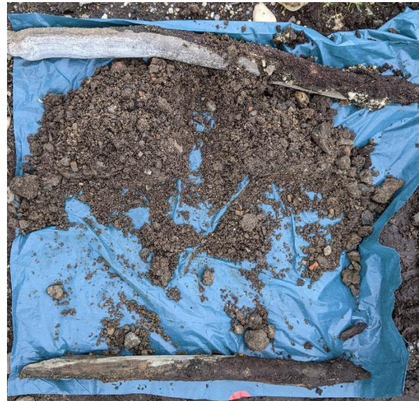
Abbildung 4-4: Probenmaterial geviertelt, 2 gegenüberliegende Teile verworfen
