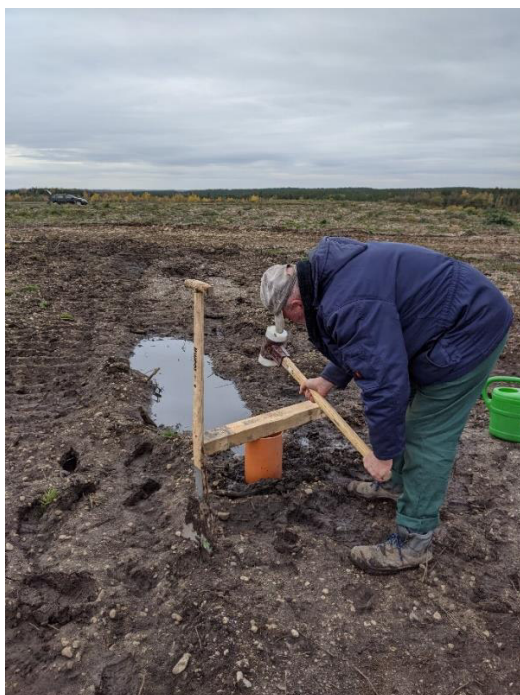
Abbildung 3-2: Einschlagen des Infiltrometer-rings
