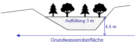
Abbildung 8-1: Schematische Darstellung des vorbergbaulichen Zustandes und der Varianten des nachbergbaulichen Zustandes.
