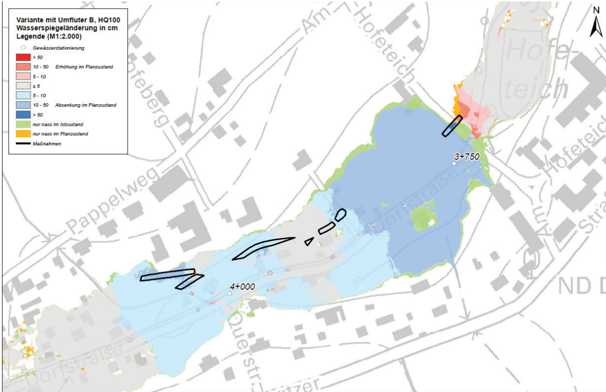
Abbildung 7.13: Wirksamkeit der Umflut Variante B, HQ100 – nicht maßstäblich (Betrachtung von Hochwasser, nicht Starkregen)
