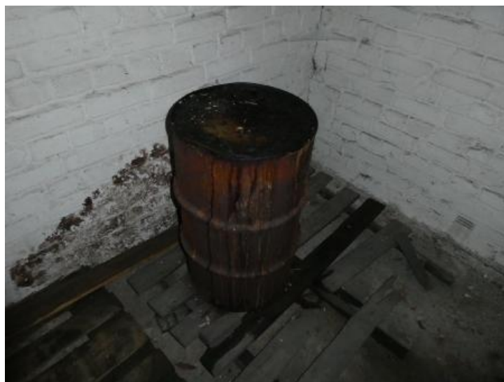
Gebäude 11 - rechter Raum: Ölfass (Altöl?) mit Verunreinigungen durch Leckagen oder Handhabungsverluste
